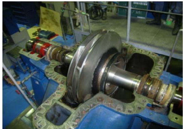
ポンプの分解状況（参考）
