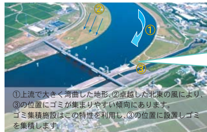
ゴミ集積施設の仕組み
