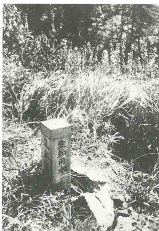
農林省によって打ちこまれた 愛知用水のベンチマーク
