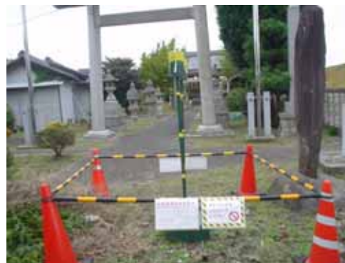
降下ばいじん調査の状況
