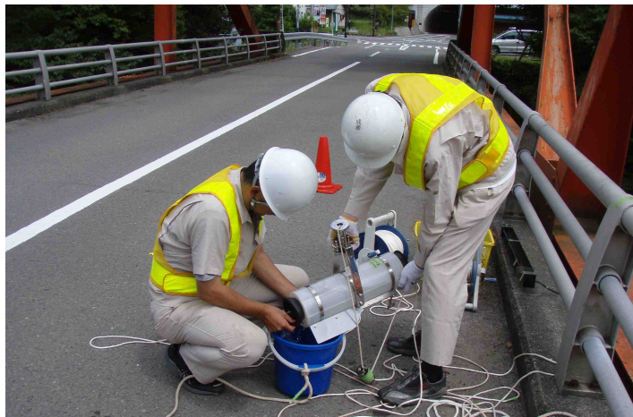
採水の状況 (バントーン採水器)
