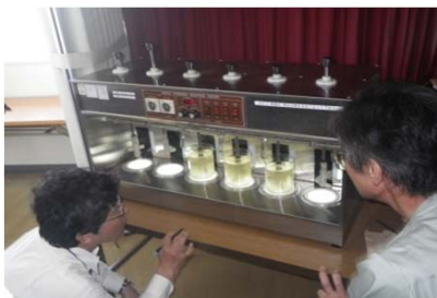
川の水に薬品（PAC）を試験的に注入し、凝集状況を確認して薬品の注入量を判断しま
