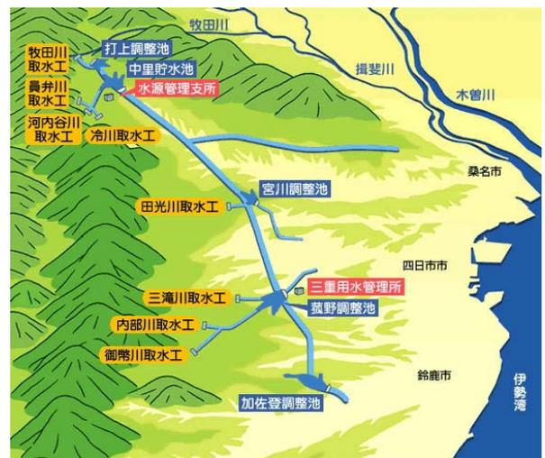
図-1 三重用水施設配置概要図
