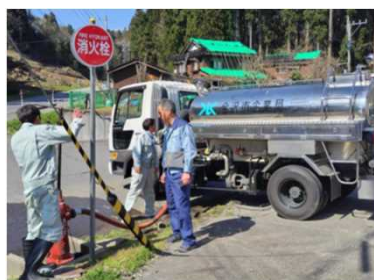
消火栓（水補給ポイント）からの給水作業
