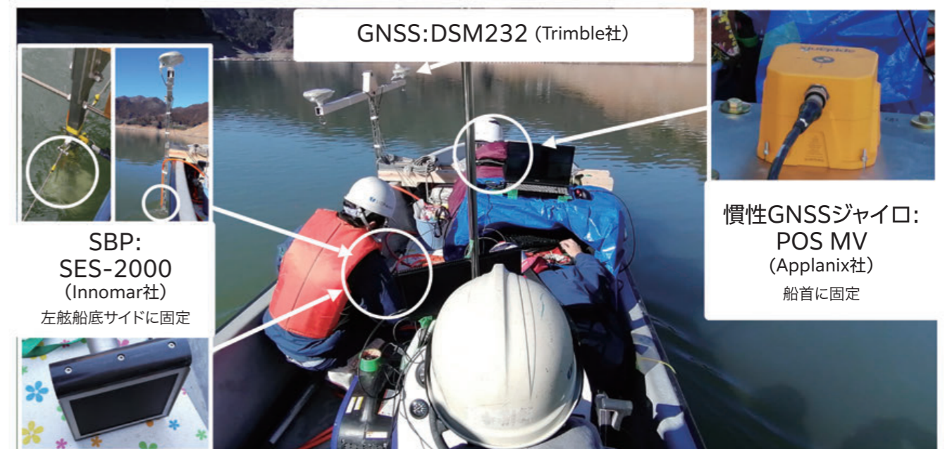
海底の堆積物調査に活用されているサブボトムプロファイラー(SBP)による調査の様子
