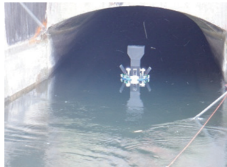
(左:通水点検装置車による背面画像撮影、右:通水台車による背面空洞調査) ICT等新技术を活用した機能診断調査(香川用水)
