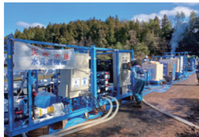
可搬式浄水装置による給水支援
