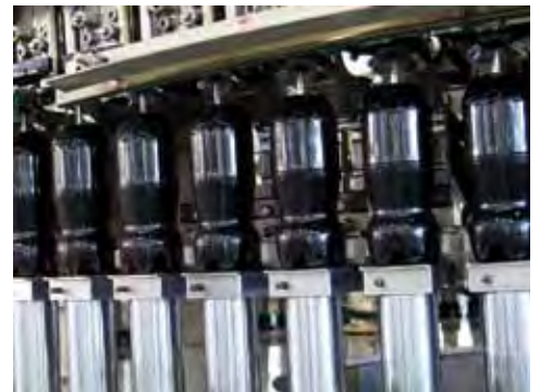
飲料を充填する機械「フィラー」
