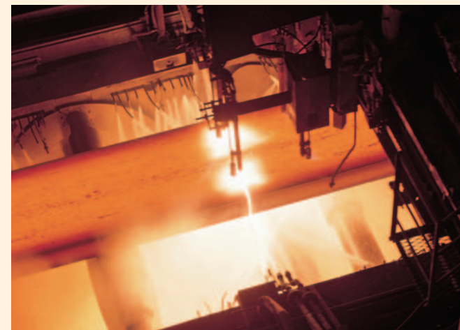
水を利用した製鋼。連続 casting でできたスラブ切断。
