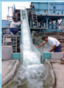
小石原川ダム洪水吐きの水理模型実験
