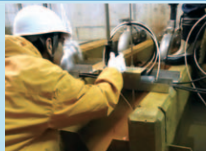
現場での浸透量測定
