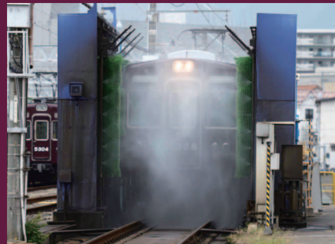
8両編成の洗車に約3.3 \text{m}^3 の水が消費される
