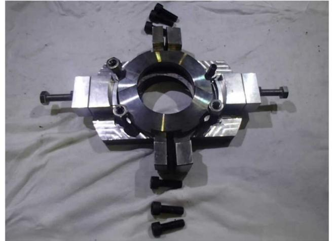
写真-8 外装型軸用漏水漏油防止装置
