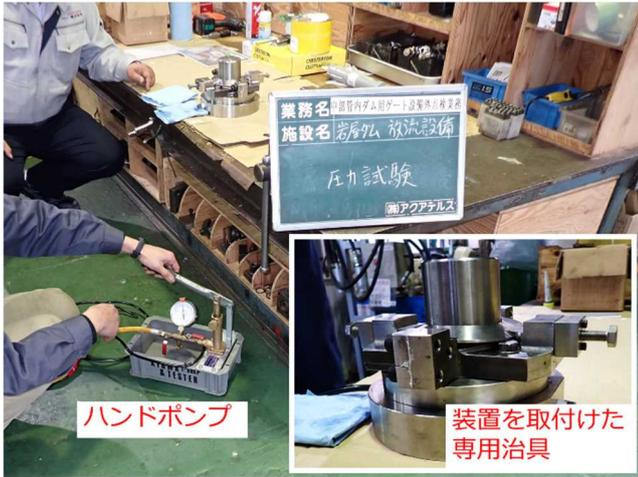
写真-6 耐圧試験の様子
