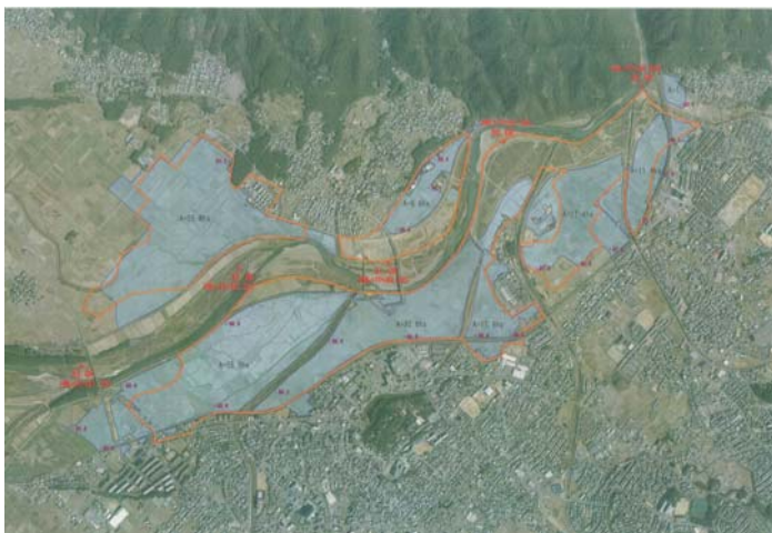
亀岡浸水区域(痕跡調査より作成)
