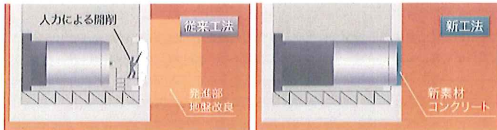
図3-3 新素材コンクリートを用いたシールドの発進・到達防護工法
