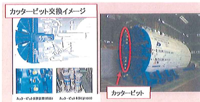
図3-5 カッタービット交換イメージ
