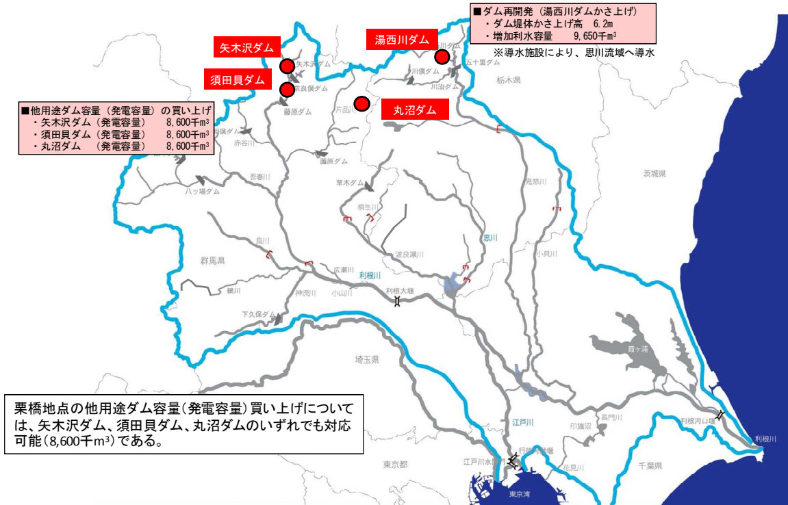
図 4.4-26 【ケース 3】 他用途ダム容量（発電容量）買い上げによる流水の正常な機能の維持対策案
