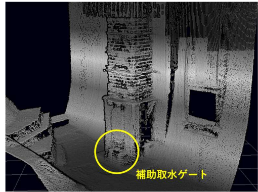
図-8 マルチビーム測深機による計測
