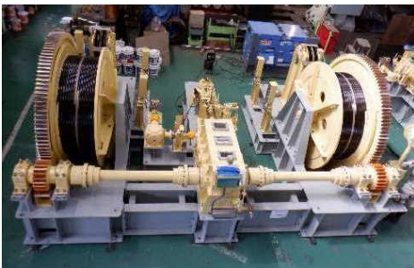
選択取水ゲート下段扉用開閉装置
