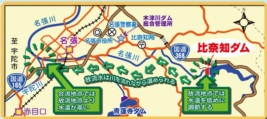
選択取水設備で取水位置を調節してダムから放流する水の水温を下げています。しかし、水温を下げすぎると、流域の田畑の農作物には悪影響があるため、比奈知ダムでは、水温や水質のチェックを持続的に行っています。
