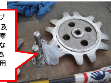
⑦下部支承部分解状況
