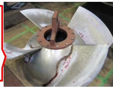
⑨浸透探傷試験中
