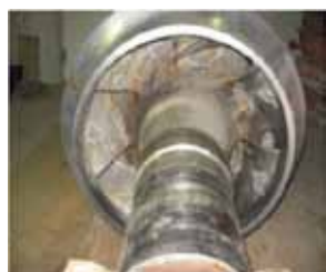
〈ポンプ羽根車の壊食状況（白線箇所）〉
