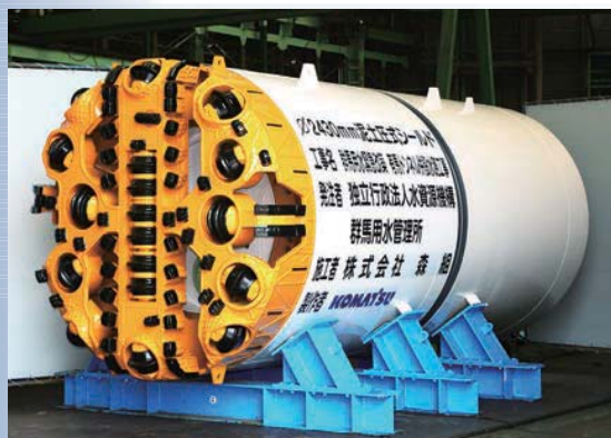
泥土圧式シールドマシン シールド外径 φ2,430mm
