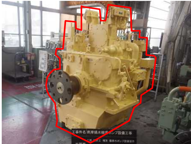
①大ポンプ原動機製作 施工状況(令和5年4月)
