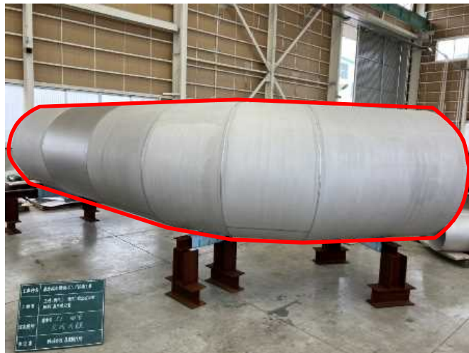
③屋外吸込管製作 施工状況(令和5年4月)
