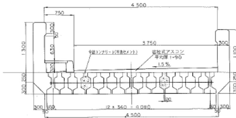
堤頂部標準断面図(越流部)
