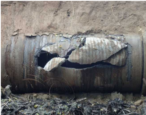
破損したPC管(φ1500mm)
