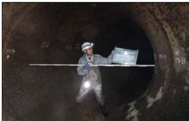
パイプの直径（縦、横）を計測し、たわみを確認。
