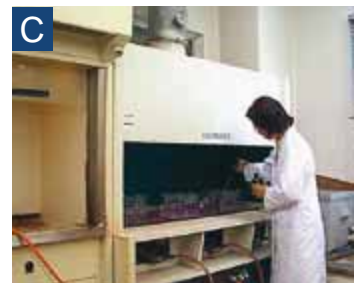
C 水質分析室での水分析状況 全国のダムでも珍しい、水質分析室を備えています。ここでは重金属等の分析や、プランクトンの計数を行います。 (管理所内にあります)
