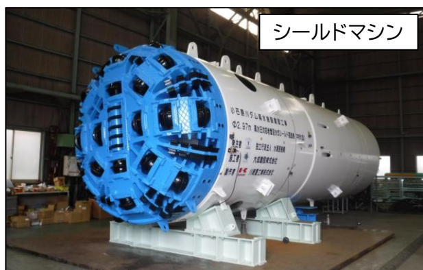
図 1-9 シールドマシン（左）と導水路トンネルの内部（右）の例
