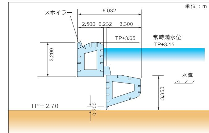
調節ゲートは、流量の調節用として平常時オーバーフロー、出水時はアンダーフローで放流するゲートです。
