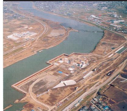
1期工事の残工事を完成させ、左岸堰柱2基、左右岸橋台2基を施工、ゲート2門の据え付けを行なった。
