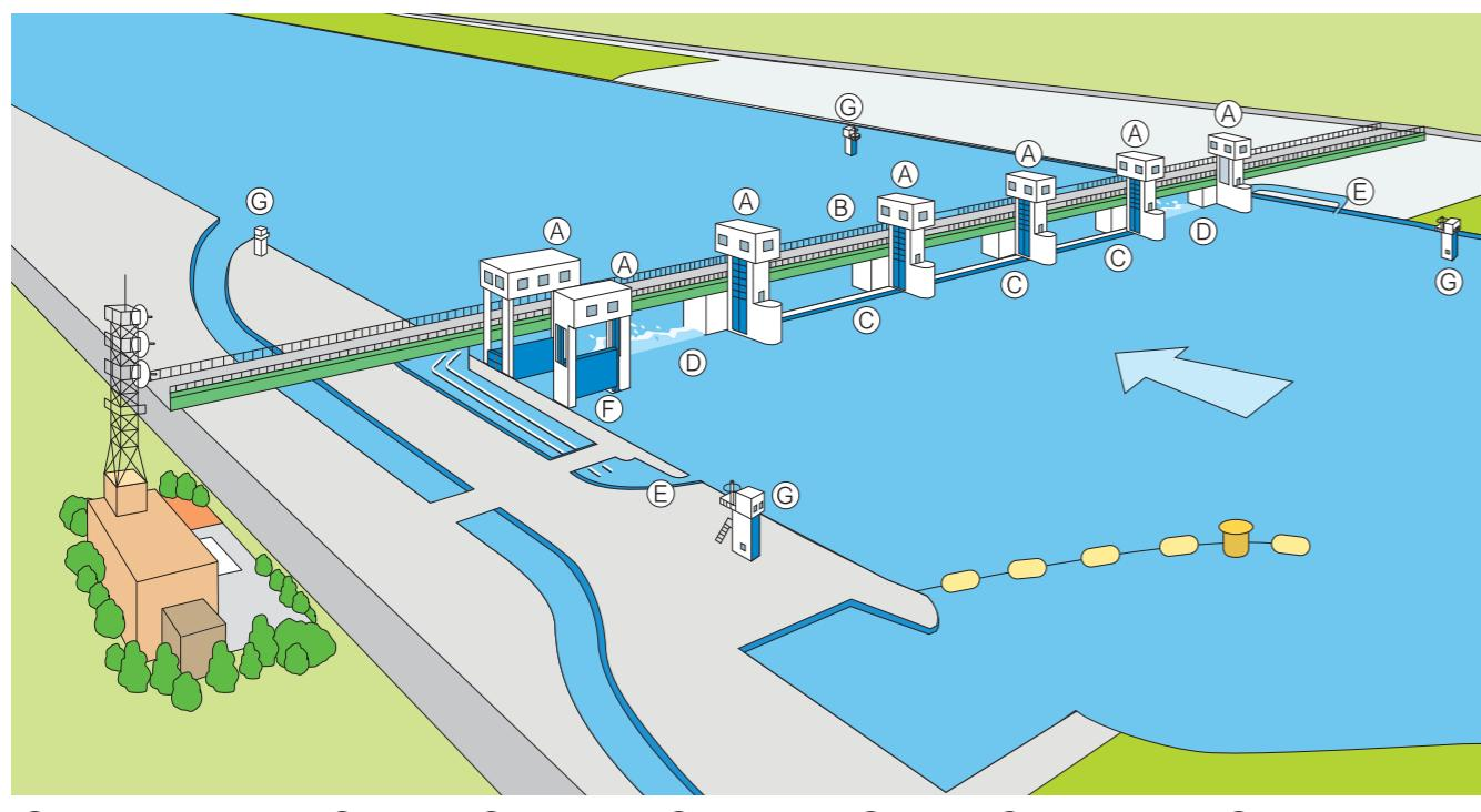
(A) ゲート開閉装置室 (B) 管理橋 (C) 制水ゲート (D) 調節ゲート (E) 魚道 (F) 閘門(舟通し) (G) 水位・水質観測設備
