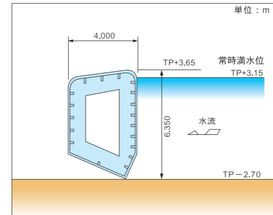
制水ゲートは、常時アンダーフローで放流するゲートです。
