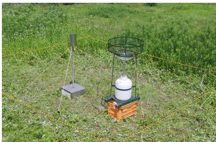
粉じん調査状況 (左:ダストジャー、右:デポジットゲージ)
