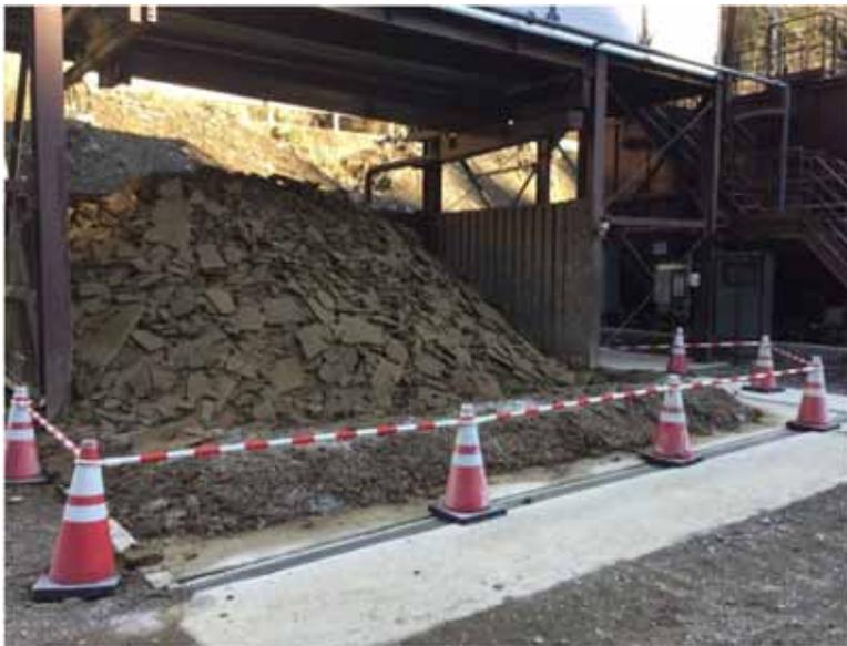
濁水処理設備にて発生した汚泥(脱水ケーキ)
