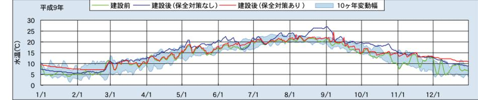
保全対策(選択取水+曝気)を実施することにより、流入水温に近い水温での放流が可能となりますが、それでも秋から冬にかけては温水放流の傾向を示しています。
