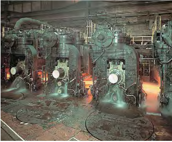
製鉄所で鋼板を作る様子
