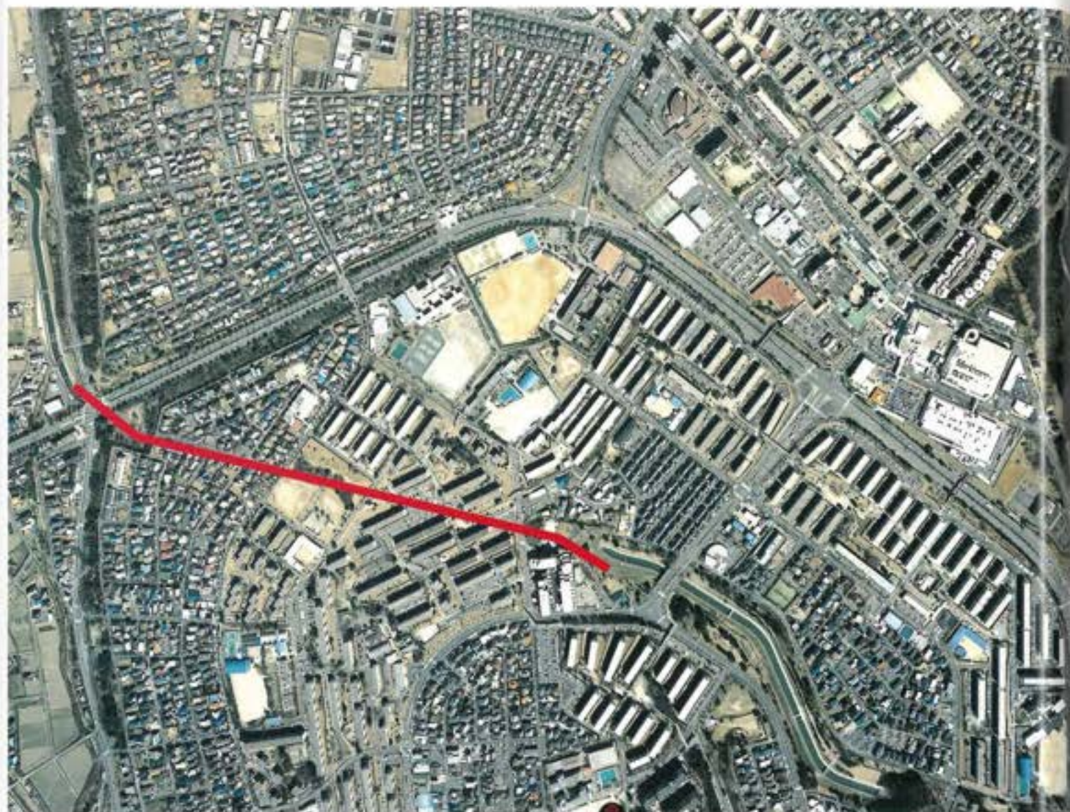
愛知用水通水後に開発された高蔵寺ニュータウン内を2階建水路としてバイパストンネルを新設した
