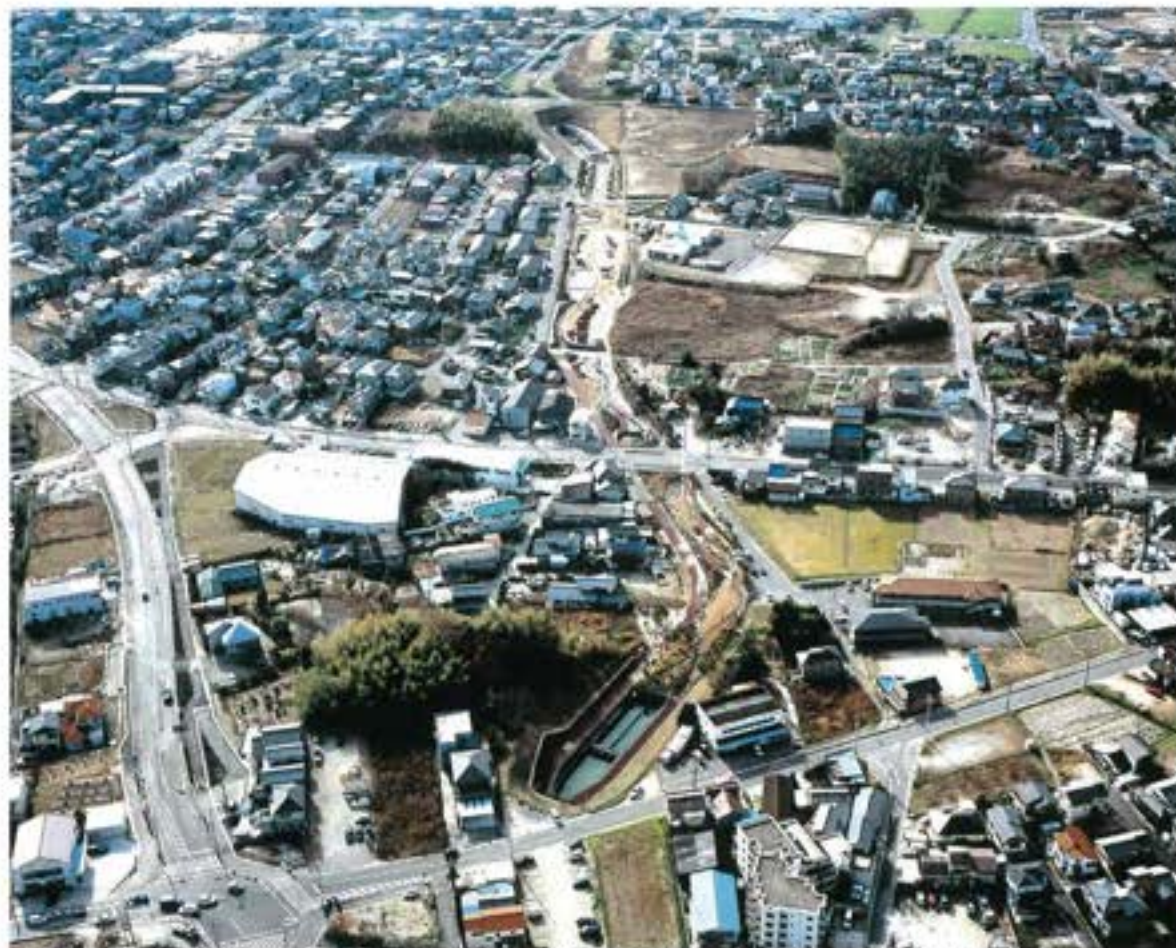
東郷第4開水路を暗渠化し（春木暗渠）上部を親水公園（涼松せせらぎの道）として利活用を図った
