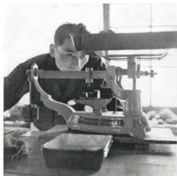
③ 正確に秤量して含水比その他のデータをとる
