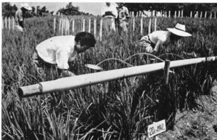
■陸稲の耕起深度別かんがい試験とテンシヨメーターによる土壌水分の測定試験
