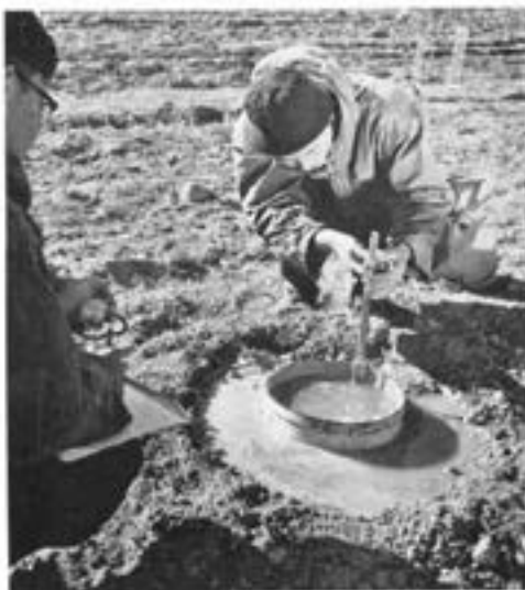
■円筒型浸透水計による浸透率の測定（緑カ丘）
