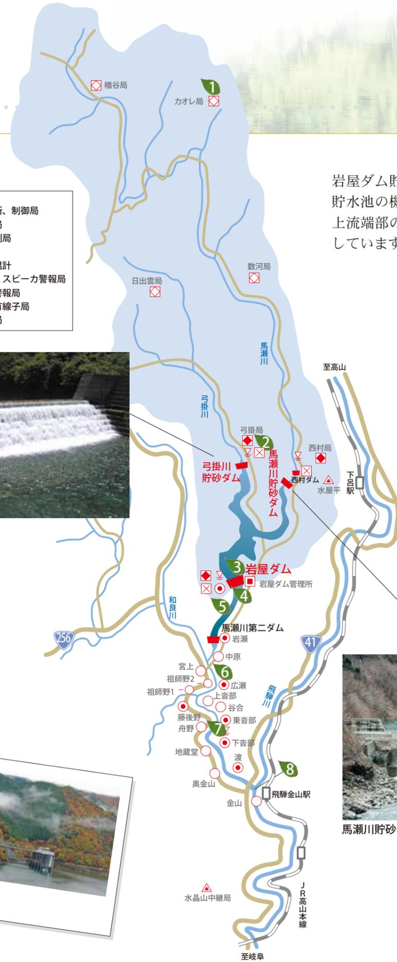
岩屋ダム貯水池の堆砂対策として、貯水池の機能の維持を目的に貯水池上流端部の2箇所貯砂ダムを設置しています。
