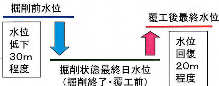
<トンネル上部の水位変化模式>
