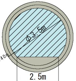
導水路トンネル 標準断面図 (河川横過部トンネル区間)
