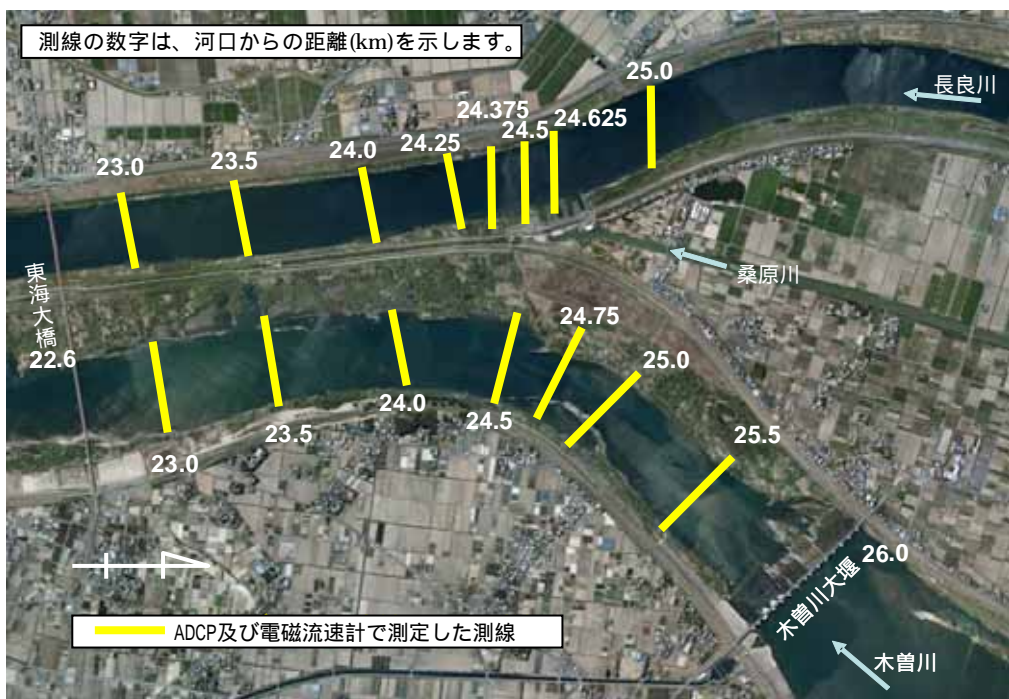
図 6.1.4-39 下流施設検討地域における調査地点 (長良川及び木曾川 河口から 22.6～26.0km 地点)
