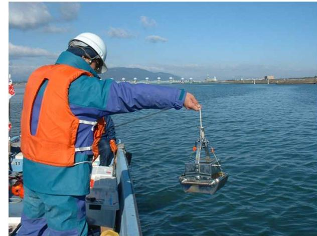
エクマンバーシ型採泥器による採泥状況
