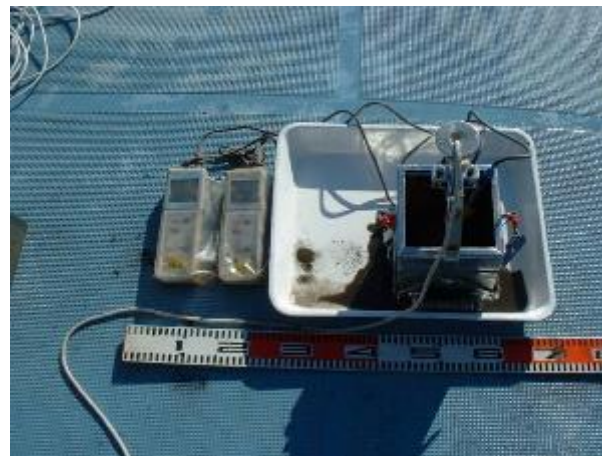
酸化還元電位の測定状況
