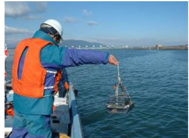
エクマンバージ型採泥器による採泥状況
