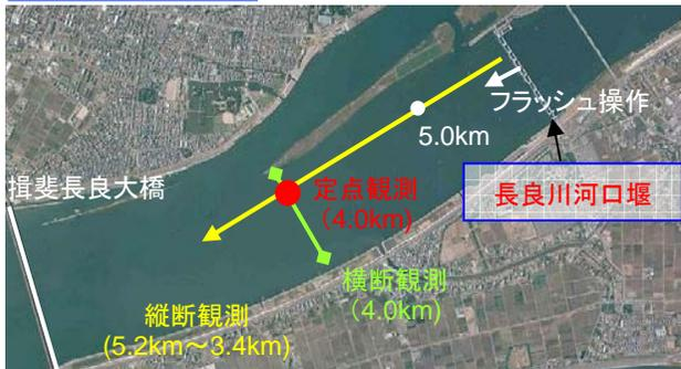
■ 操作時流量・水位等 ● 操作ゲート:5,6,8,9号 (開度110cm)
