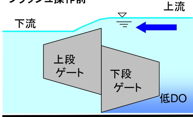
河口堰運用後は、DOの低い塩水塊の侵入が無くなり、堰上流の底層DOは、汽水域であった頃比べ改善しました。夏期には、水温が上昇することにより表層と下層の温度差による密度差が生じ、下層の水が動きにくくなり、一時的に底層のDOが低下する場合があります。
