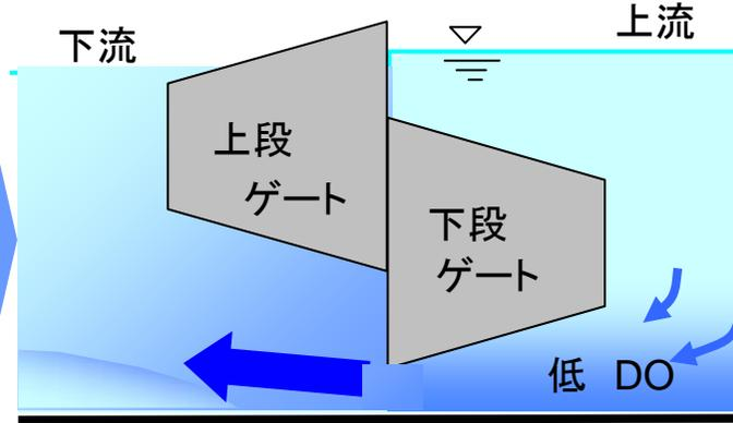
底層の低いDOの河川水を勢いよく流下（フラッシュ操作）させることにより、塩分が侵入しない範囲内で、下層に流動を生じさせ、底層DOの低下を防ぎます。さらに、流下した水は下流での混合等によりDOの改善効果が期待されます。
