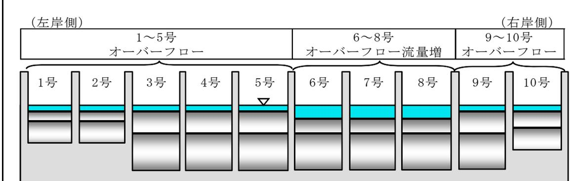
(注) 伊勢大橋地点の表層のクロロフィル a 濃度が、 $40 \mu\text{g/L}$  を上回るとき、オーバーフローによるフラッシュ操作を実施することがあります。
