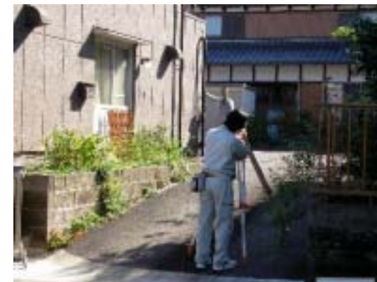
家屋基礎のレベル調査
