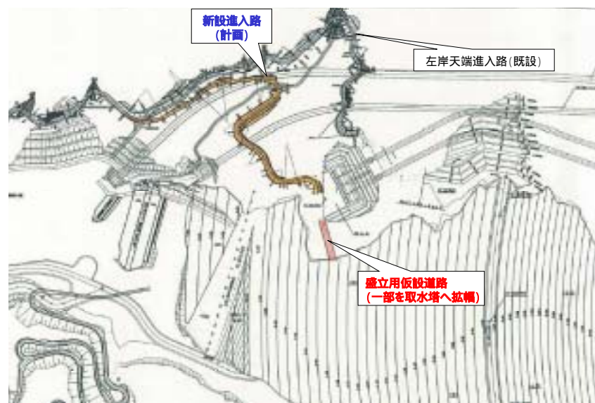
工事用進入路の取りやめ
