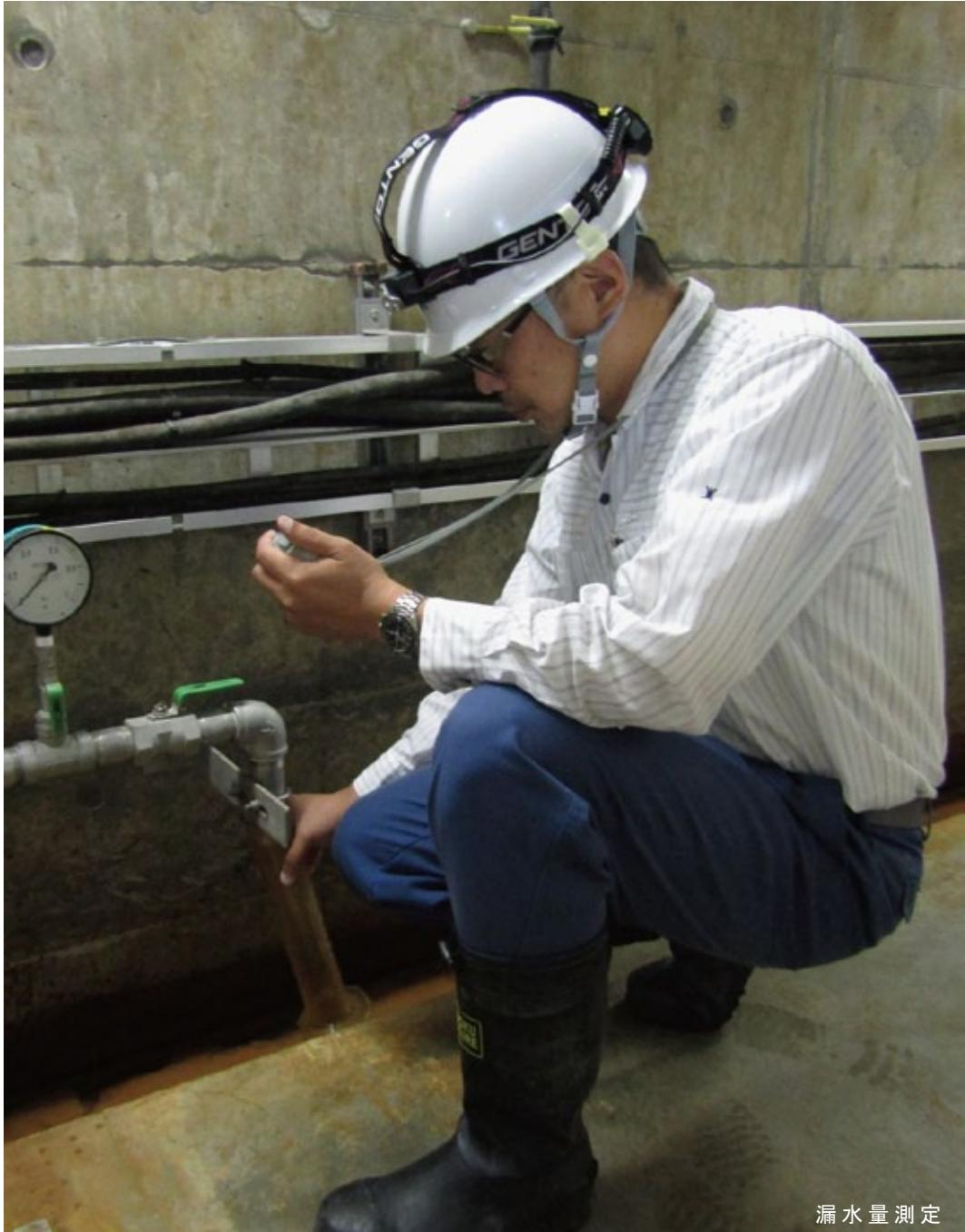
漏水量測定
