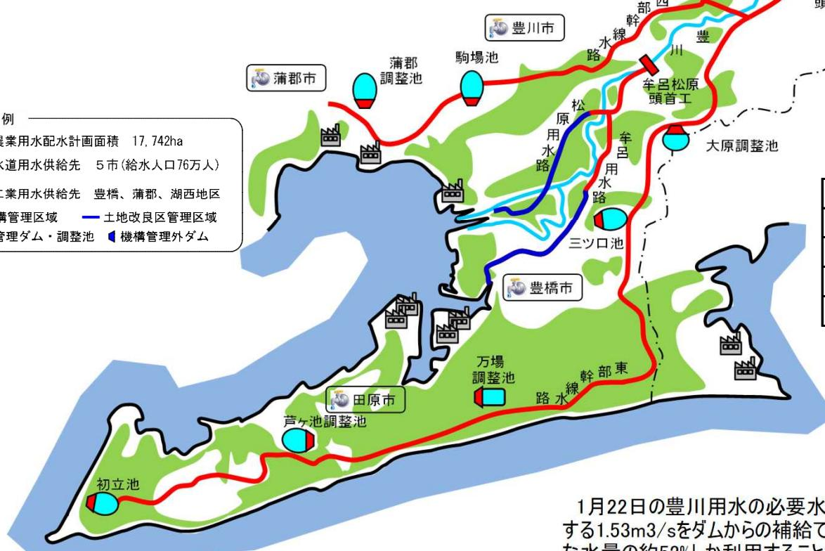
1月22日の豊川用水の必要水量は約3.22m<sup>3</sup>/sであり、そのうち1.69m<sup>3</sup>/sを河川の自流から取水し、不足する1.53m<sup>3</sup>/sをダムからの補給でまかなっています。(ダムからの補給がなければ、豊川用水受益地域で必要な水量の約52%しか利用することが出来ません。)
