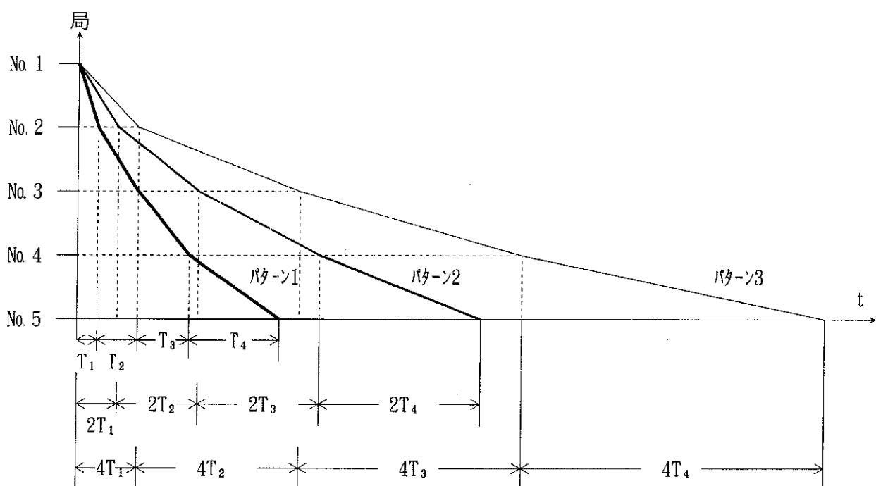
放流パターン1で局毎の局間タイマ( $T_1 \sim T_4$ )を決定すれば、放流量が変わると理論上局間タイマの倍率が変わるだけとなる。
