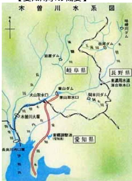
愛知用水は、牧尾ダムなどを水源として愛知県と岐阜県に農業用水、水道用水及び工業用水を最大30m<sup>3</sup>/s供給する幹線水路延長約110kmの施設である。
