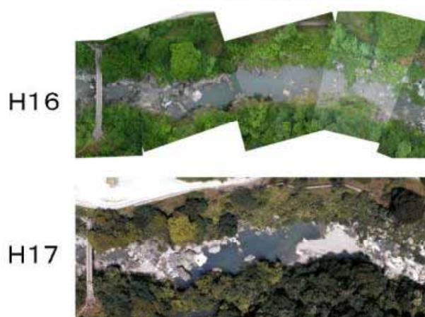
写真-10 土砂供給による河川状況の変化（下久保ダム）
